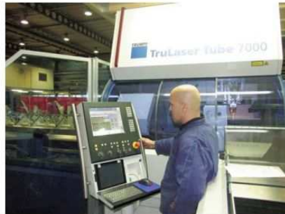
De TruLaser Tube 7000 kan door elkaar profielen van 15 tot 200 mm snijden zonder dat hij omgesteld moet worden.
