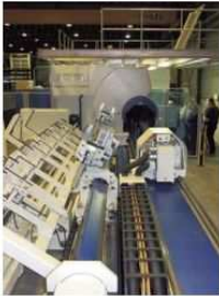
Vanuit een bundelmagazijn (links op de foto), dat tot 4 ton materiaal kan bevatten, wordt de TruLaser Tube geladen.
