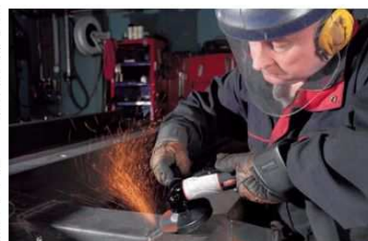
De G2510 slijpmachine levert 800 W en is geschikt voor gebruik met vlakslijp- en doorslijpschijven van 115 en 125 mm doorsnede.
