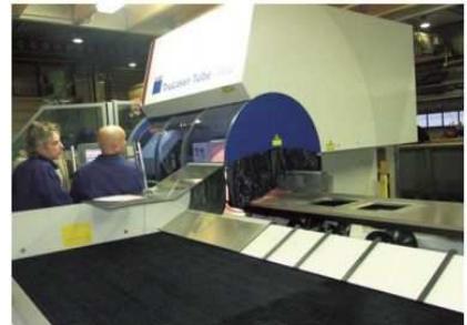
Na het snijden verhuist de gesneden buis of koker naar een borsteltafel of werpt het delen in een opvangbak achter de machine.
